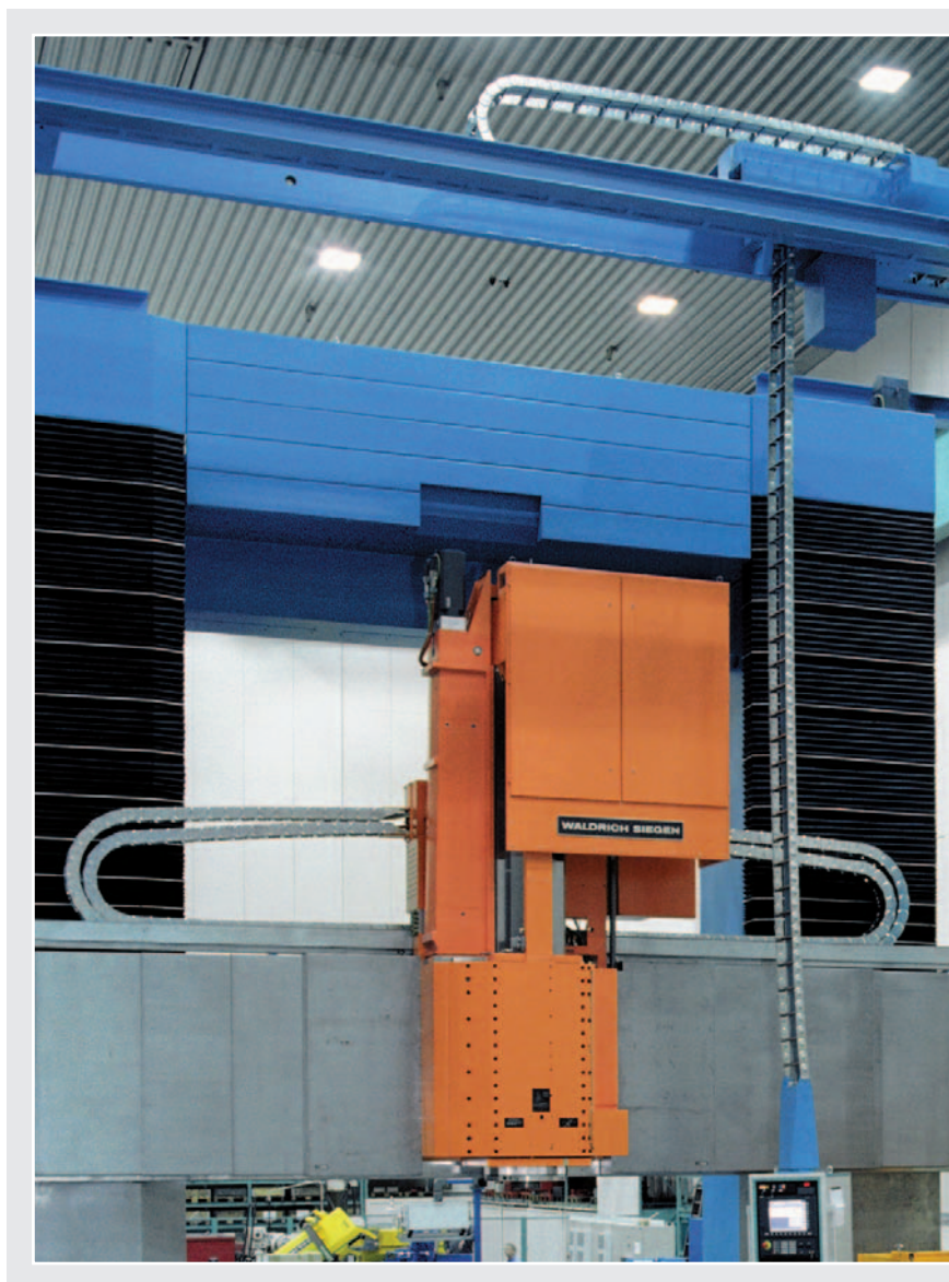
Steel cable carriers on a gantry milling machine. Photograph: Waldrich Siegen Werkzeugmaschinen GmbH
