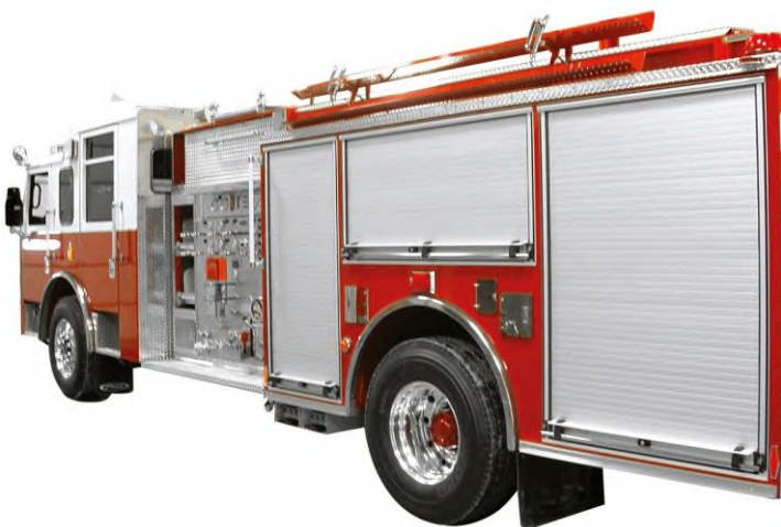
Сдвижные двери ролетного типа из алюминиевых ламелей/ Roll-up compartment doors
