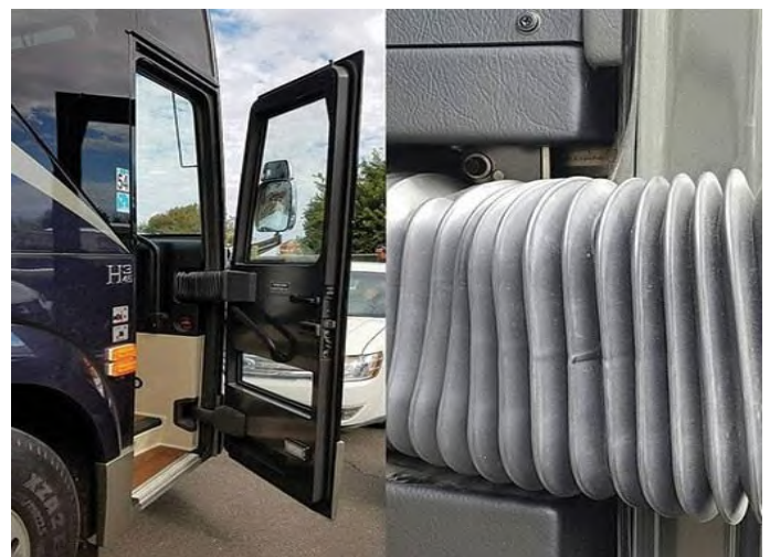
Резиновые сильфоны для защиты шарнирных соединений дверей, коробок передач и пр. Molded rubber bellows for pinch points protection
