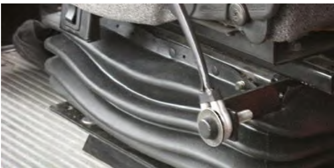
Сильфоны для регулировки водительского сидения Bellows for driver's seat adjustment
