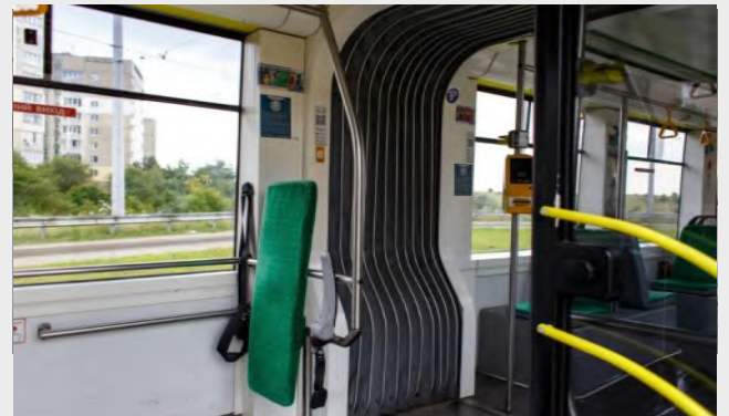
Гофрозащиты для герметизации проходов между вагонов железнодорожного и городского транспорта
